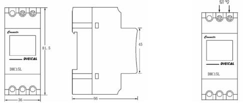
当累时器的控制端输入 AC/DC100~240V 电压时累时器开始计时
