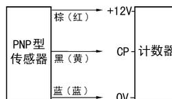
3. 传感器的电压应与计数器的辅助电源输出的电压相符. 传感器的总电流应不大于计数器辅助电源的最大输出电流.
